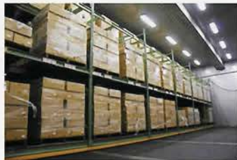
定温倉庫内は電動式移動ラックにより、省スペースを実現。作業中の場所のみ蛍光灯が点灯、省エネと温度管理には注意を払う。
