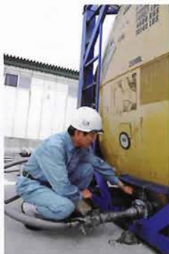
搬入された化学薬品を加熱。コンテナタンクの中の薬品を固体から液体にして、荷主に引き渡す。多様なニーズや輸送プランニングにも対応する。
