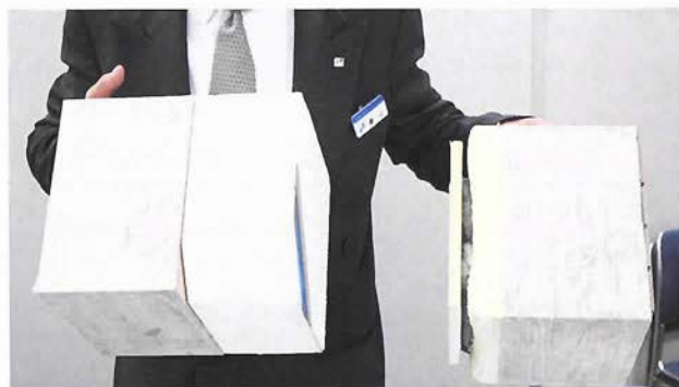
左が、外断熱のサンプル。白い部分が断熱材。右は、内断熱のサンプル。
