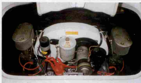
(上) 右側面のカスタムコーチワーク ロイター社のラベル (下) 空冷 水平対向4気筒のエンジン
