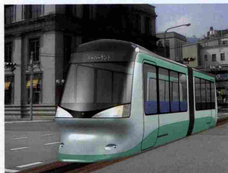
④1本のレールの上を走ります。動輪がセンターにレイアウト (左右の補強輪)され、低床化を実現します。〈デザイン・登 正治〉
