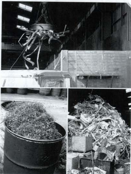
(上)磁石にくっつく金属とそうでないものを分別 (右下)高寄商店に運び込まれた廃材 (左下)再利用が可能な原材
