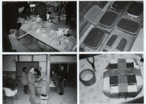
タッパーにゴムを敷くとゴムの厚さ分だけコンクリートの表面に差ができることを利用してフォルムを作る
