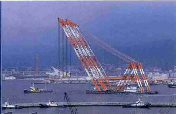
神戸港に停泊中の日本最大の起重機船「海翔」（4100t）。甲子園球場の超満員の観客を丸ごと持ち上げるほどの力持ち
