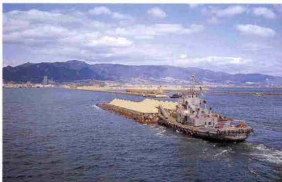
ポーツアイランド埋立ての際、一度に1000m 3 もの土砂を積んだ土運船を押し「第8神海丸」（1966年頃）
