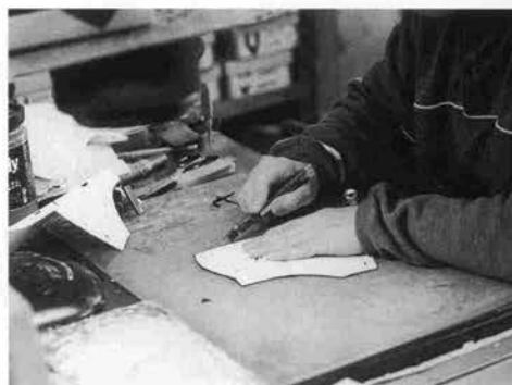
写真上／型紙に沿って皮を切り取る作業 写真下／平面の簡単な型紙から立体的な靴ができあがる。 必要な人には仮縫いまで行う
