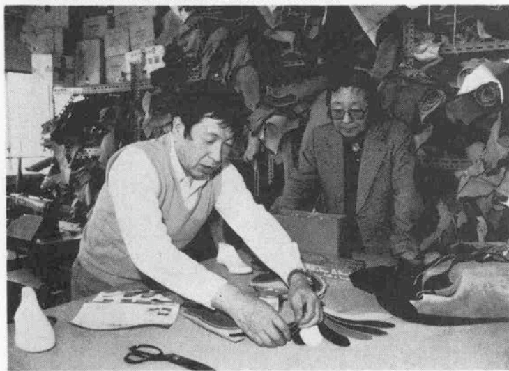
皮の裁断は頭から尾の方向に沿って切りとられる。よりいっそうにぴったりと合う靴を作るための細やかな配慮がなされている。
