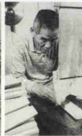
▲梃びき機で木皮を カマボコ状にした 後、小割りにする。
